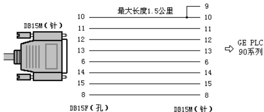
因 IC690USB901 和 PLC 内部已安装有终端电阻, 所以外部接线时无需再接终端电阻。
