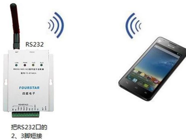
图 2-1 连接 FS-BT485A 的串口
