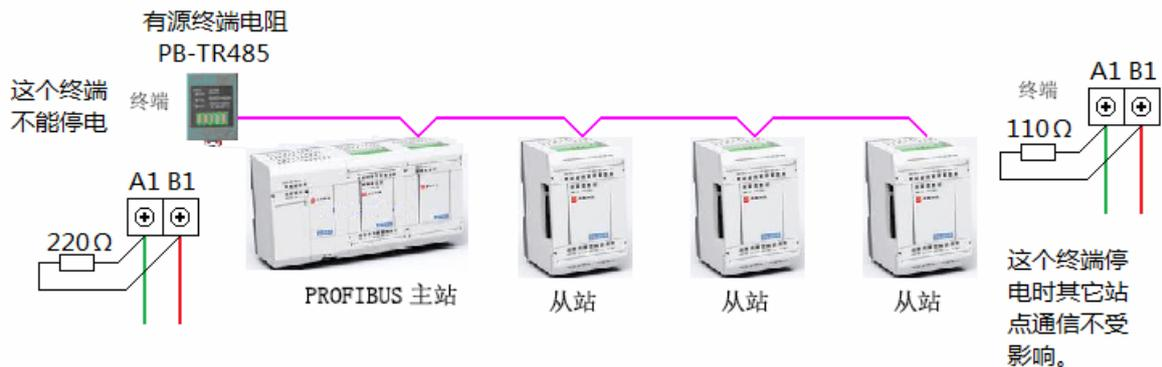
图1-5 无需给一个终端电阻供电的方案
