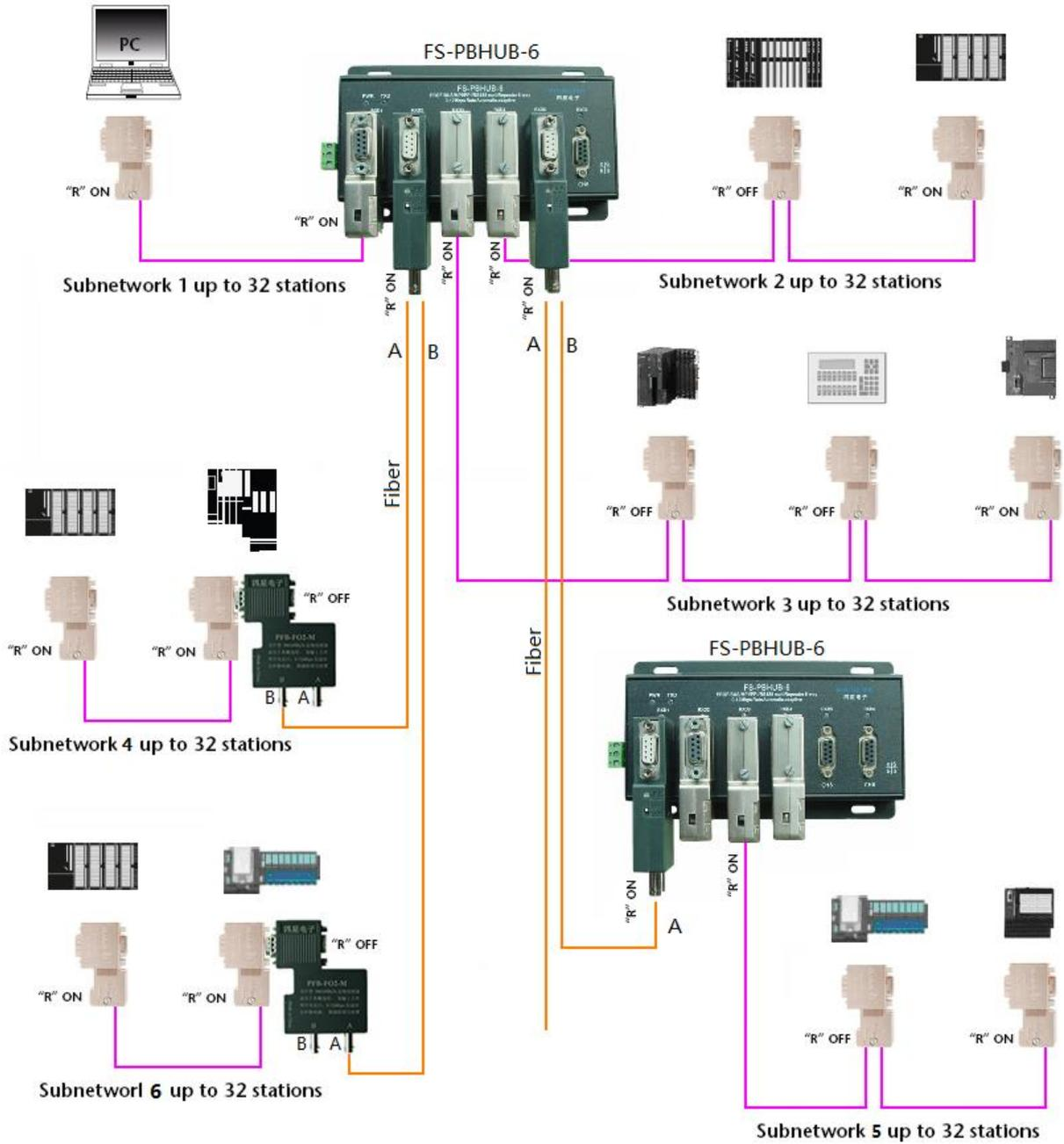
图 5-4 光纤型 PROFIBUS 总线连接器与 PROFIBUS 集线器组成混合型光纤连接
