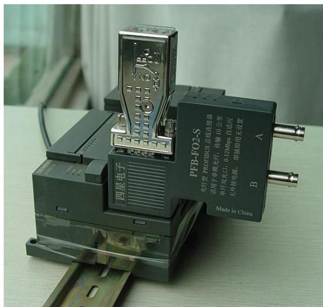
C、先在设备的 PROFIBUS/MPI/PPI 标准 DB9F 插座上插入一只带编程口的总线连接器以便于用电缆去连接其他站点，再在其上面插入光纤型 PROFIBUS 总线连接器。
