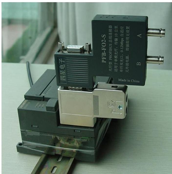
D、对于像 CP5611、CP5613 之类的 PROFIBUS 板卡，也可直接将光纤型 PROFIBUS 总线连接器插到板卡的 DP 插座上，使之成为采用光纤传输的 PROFIBUS 通讯板卡。
