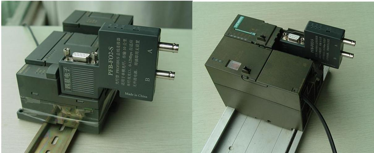
B、先将光纤型 PROFIBUS 总线连接器插入设备的 PROFIBUS/MPI/PPI 标准 DB9F 插座，再在其上面插入一只 180 度（直形）的总线连接器以便于用电缆去连接其它站点。
