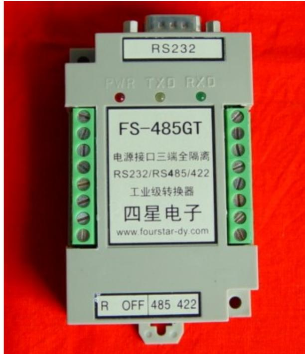
FS-485GT 是一款特别适合工业应用的 RS232 到 RS485 和 RS422 的隔离转换器，该产品内部采用了两个 DC/DC 隔离电源模块和高速光偶，实现了电源与 RS232 和 RS485/422、RS232 与 RS485/422 的全部隔离，供电电源采用了 9~40VDC 宽电压输入，不怕电源电压抖动对通信的影响。采用特有的无延时自动收发转换技术和波特率自适应技术，即插即用适合所有软件，并且在不发送数据的待机状态时输出为高阻态，支持多点通信，有别于市售的其它同类廉价产品。本产品内置防静电抗雷击电路，独具电源和收、发指示灯，外形为标准导轨安装的工业结构。
