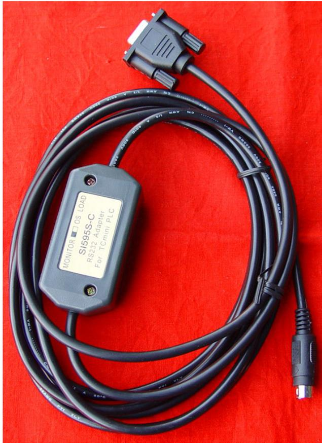
SI595S-C 是用于东芝 TCmini 系列 PLC 的通信适配器，也称编程电缆，它与日本东芝生产的适配器 SI595S 完全兼容但体积小了很多，使用更为方便。使用 SI595S-C 适配器和 TCPRGOS-W(J)等软件可实现对东芝 TCmini 系列 PLC 的编程及程序数据上载、下载、监控等操作。
