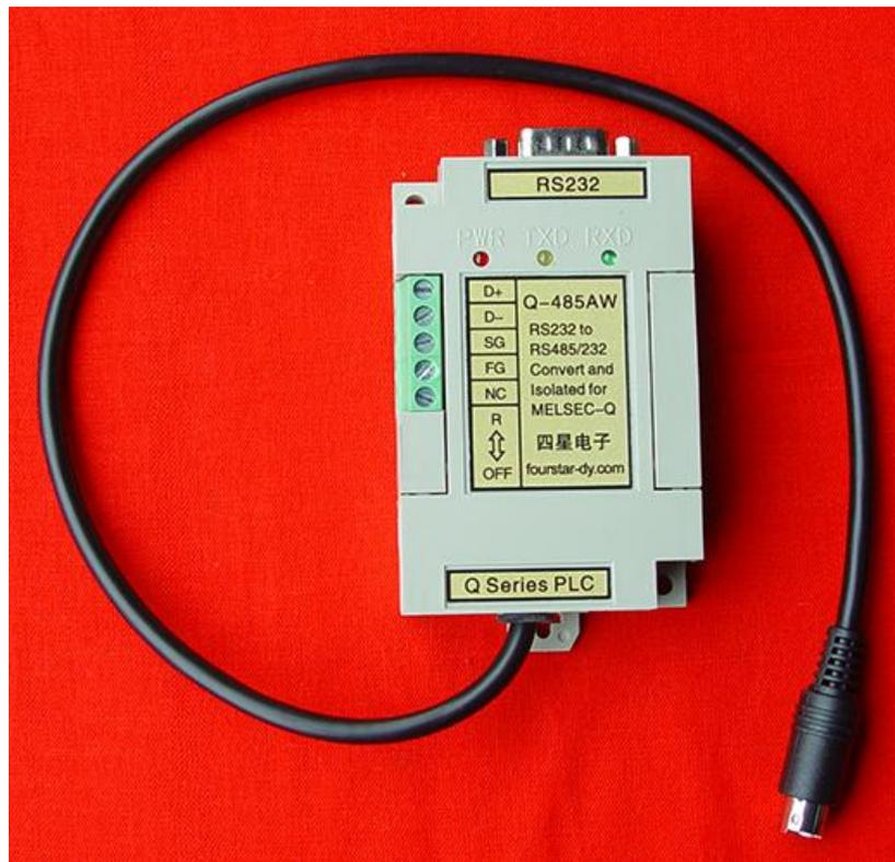
三菱 Q 系列 PLC 的编程口为 MD6F 母座的 RS232 接口，常用于连接上位计算机、触摸屏以及其它串口设备通讯，允许最大电缆长度为 15 米。当超过 15 米时需将其 RS232 接口转换为 RS485 接口通讯。Q-485AW 就是四星电子转为此应用而设计的一款用于三菱 Q 系列 PLC 编程口转 RS485 适配器（三菱并无此产品），实现将 Q 系列 PLC 的编程口（RS232）转换成二线的 RS485 信号进行远距离传输，最大通信距离可达 1200 米，内部采用光电隔离抗干扰设计并内置防雷击浪涌保护电路，特别适合恶劣的工业环境。四星电子同时在 Q-485AW 上设计了隔离的 RS232 接口，以满足 PLC 与上位机的近距离通信，使用更为方便。
