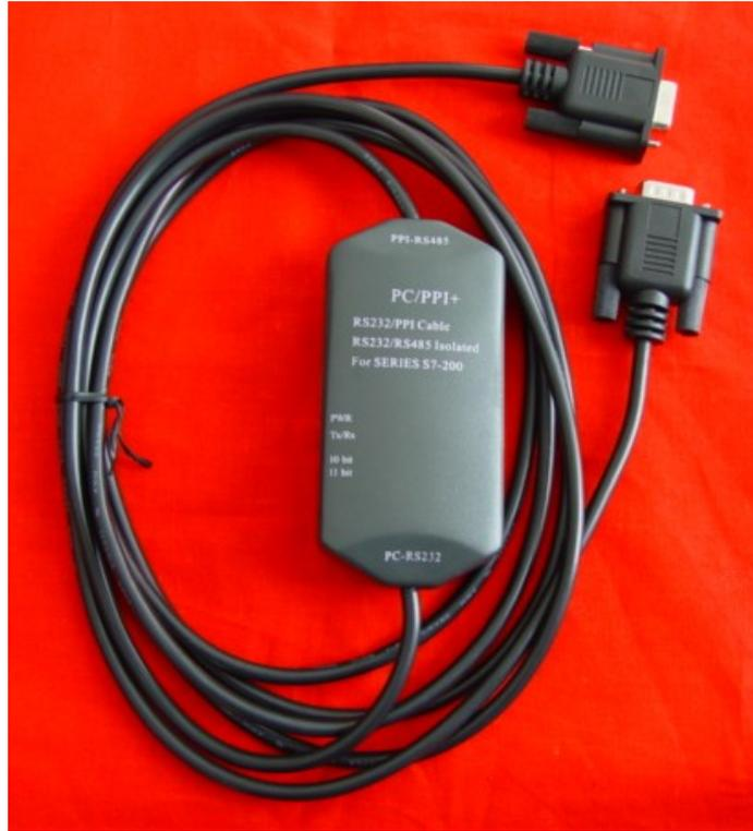
PC/PPI+编程电缆为 RS232 到 PPI 接口（RS485）的转换电缆，适用于西门子 S7-200 系列 PLC 和 TP170 触摸屏编程、通信和监控，支持 PPI 协议和自由口通信协议，并可使用 MODEM（调制解调器）通过电话线远程通信，光电隔离和内置的防静电、浪涌等瞬态过压保护电路很好地解决了容易烧通信口的问题，特别适合环境恶劣的工控现场长期监控通信。
