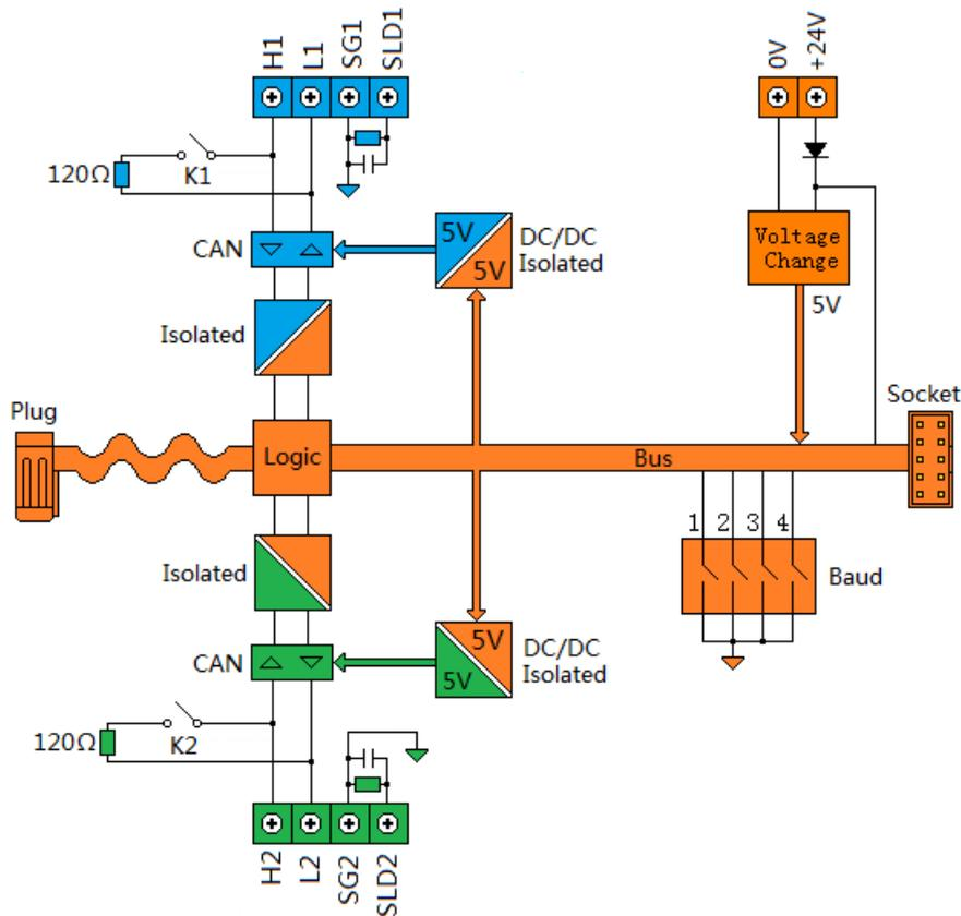
图 5-1 四星电子 FS-CAN-RPT 中继器集线器原理框图
